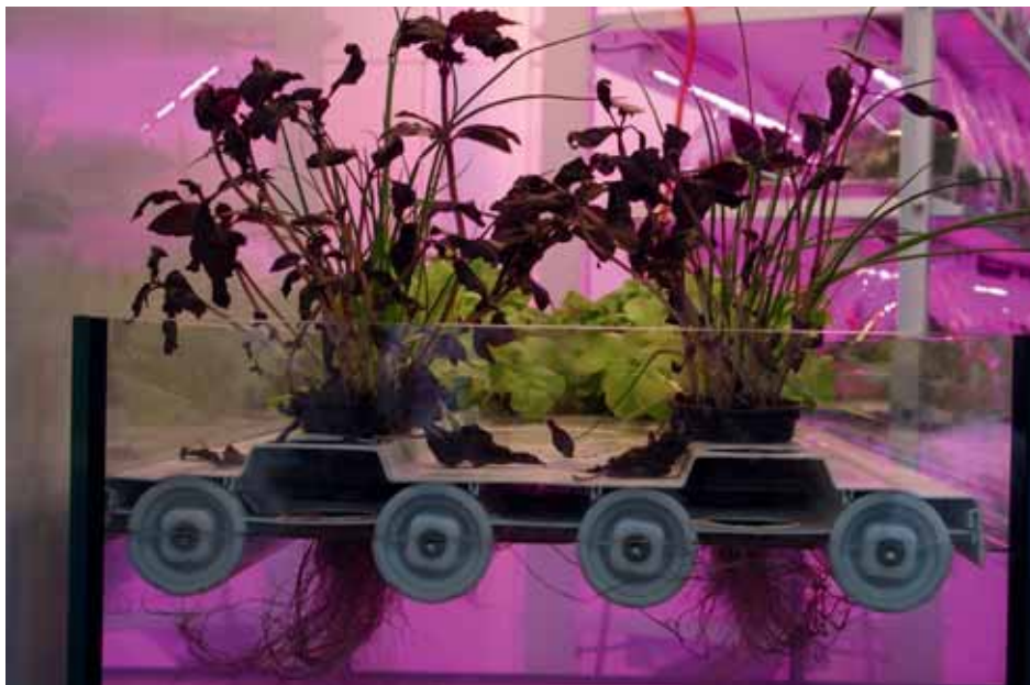
Een dwarsdoorsnede van de 'floats' van Viscon Hydroponics.
