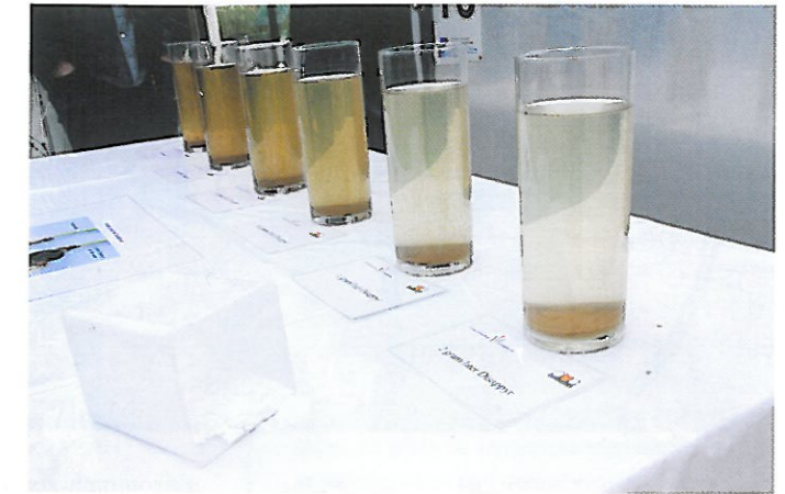
De polymeer Disappyr (het witte poeder in het bakje) helpt tegen bruinverkleuring van water. Het onoplosbare middel bindt fenolen. De dosering in de vazen loopt op van 0 tot 2 gram per liter.
