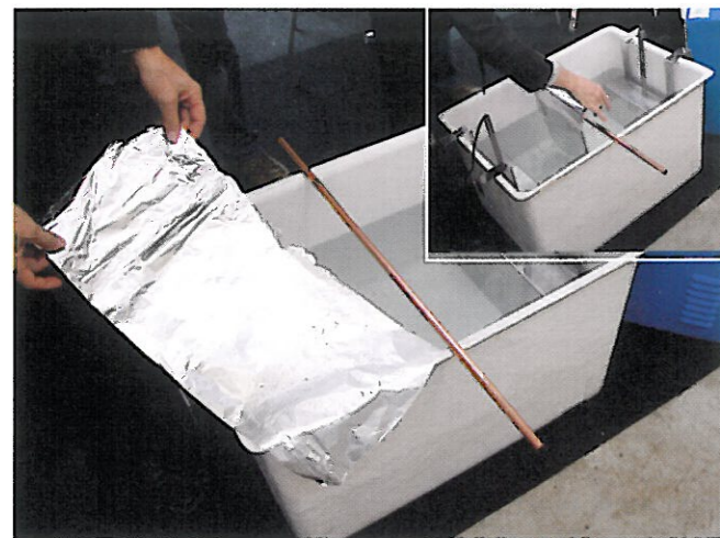
Ultrasoon geluid is sterk. Aluminiumfolie wordt geperforeerd als het even in een bak water hangt, terwijl de boxen aan staan.
